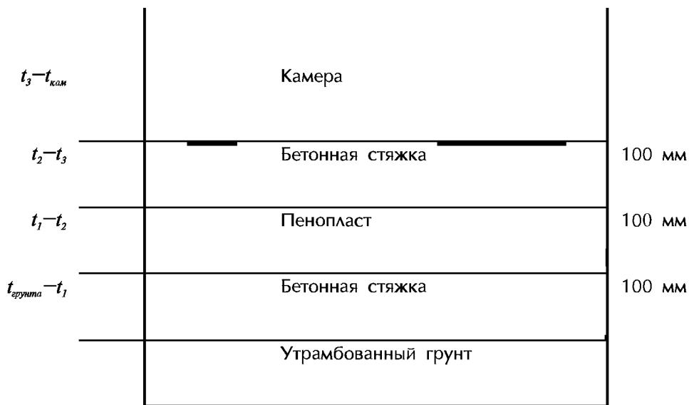
Рис. 2. Поперечный разрез пола камеры
