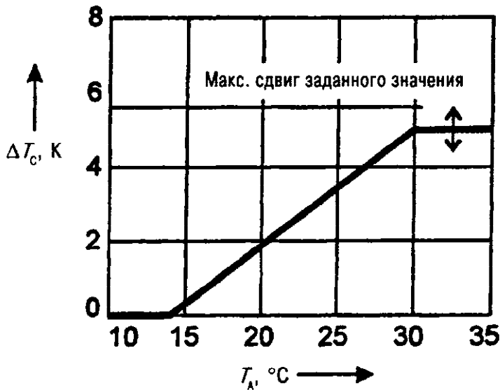
Рис. 4.76. Сдвиг заданного значения температуры конденсации T_C в зависимости от температуры наружного воздуха T_A
