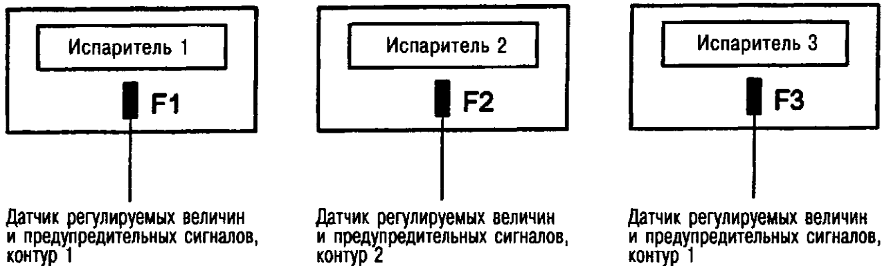
Рис. 4.77. Расположение чувствительных элементов датчиков относительно регулируемых контуров (охлаждаемых объектов) 1–3
