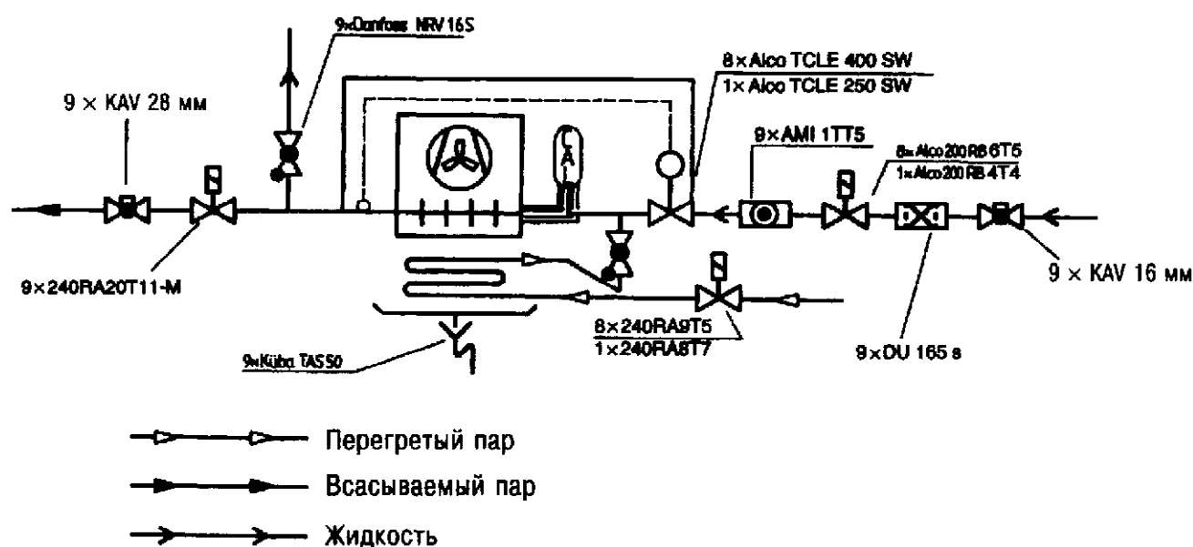
Рис. 4.54. Элементы системы управления и контроля испарителей
